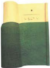
KW-004 กระเบื้องดินเผา ลอนกนกกล้วยไฟสูง (ระยะแวง 17-18 cm) ขนาด 20x28x1 cm 1.6 kg./pc. 30 pcs./m 2
